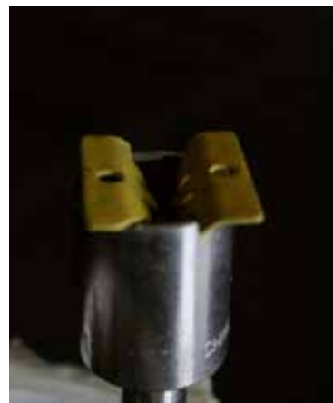
13er Nuss als Aufnahme- und Versetzwerkzeug für die gelben Panel-Klammern
